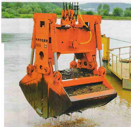
Der 5 m3 fassende Kröger Greifer vom Typ 5003 MUG im Einsatz an der Drehkrananlage beim Kieswerk Durant.
